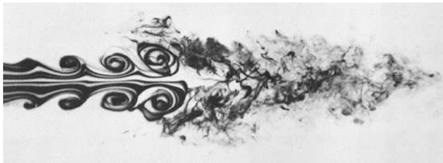
FIG. III.1 – Illustration de la transition laminaire-turbulent. Un jet d'air issu d'un cylindre d'ouverture circulaire s'écoule de la gauche vers la droite avec un nombre de Reynolds de l'ordre de 10000 (voir le III.2.c) et est rendu visible par l'injection de fumée. On voit la fin, à l'extrême gauche, du régime laminaire, puis le développement d'instabilités, de tourbillons formant une double allée de Bénard et von Karmann, puis l'installation abrupte du régime turbulent, à droite. Image issue de [van Dyke, 1982].
