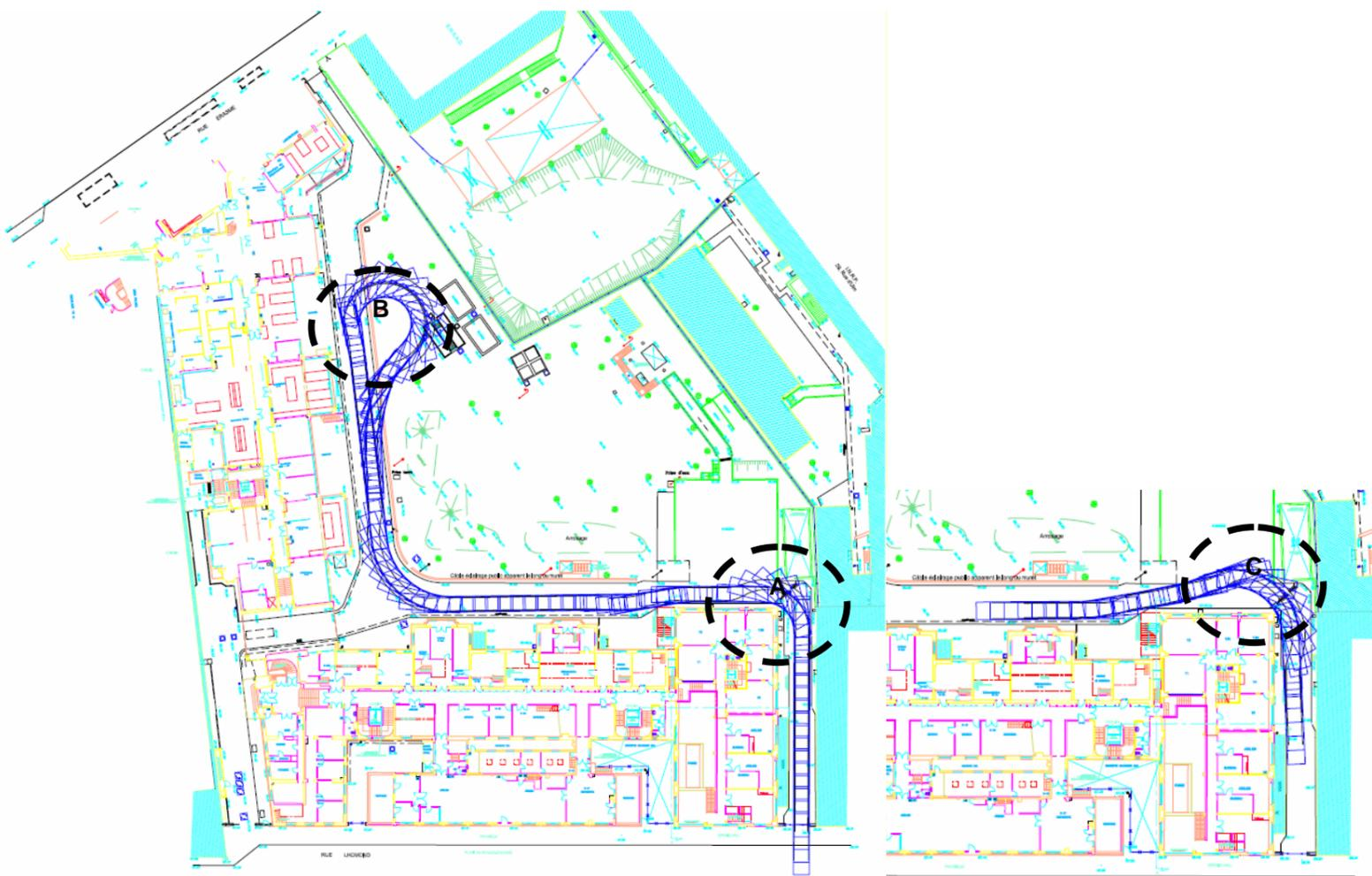
A : afin de faciliter la giration, l'extrémité du local fluide est à combler et modifier en voirie
